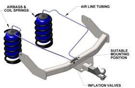
AIRLINE ROUTE SHOWN IS EXAMPLE ONLY SEE RELEVANT COIL SPACE ROUTING
